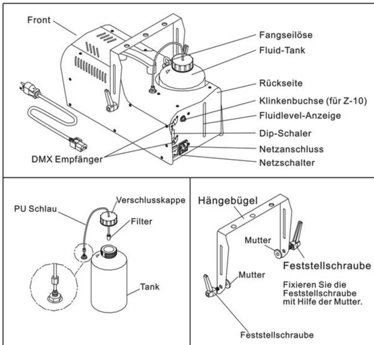
**Hinweis:** Das Gerät besitzt einen Flüssigkeitsspiegel. Die Maschine stellt den Nebelbetrieb ein, wenn der Pegel niedriger ist als es für den Betrieb nötig ist.
