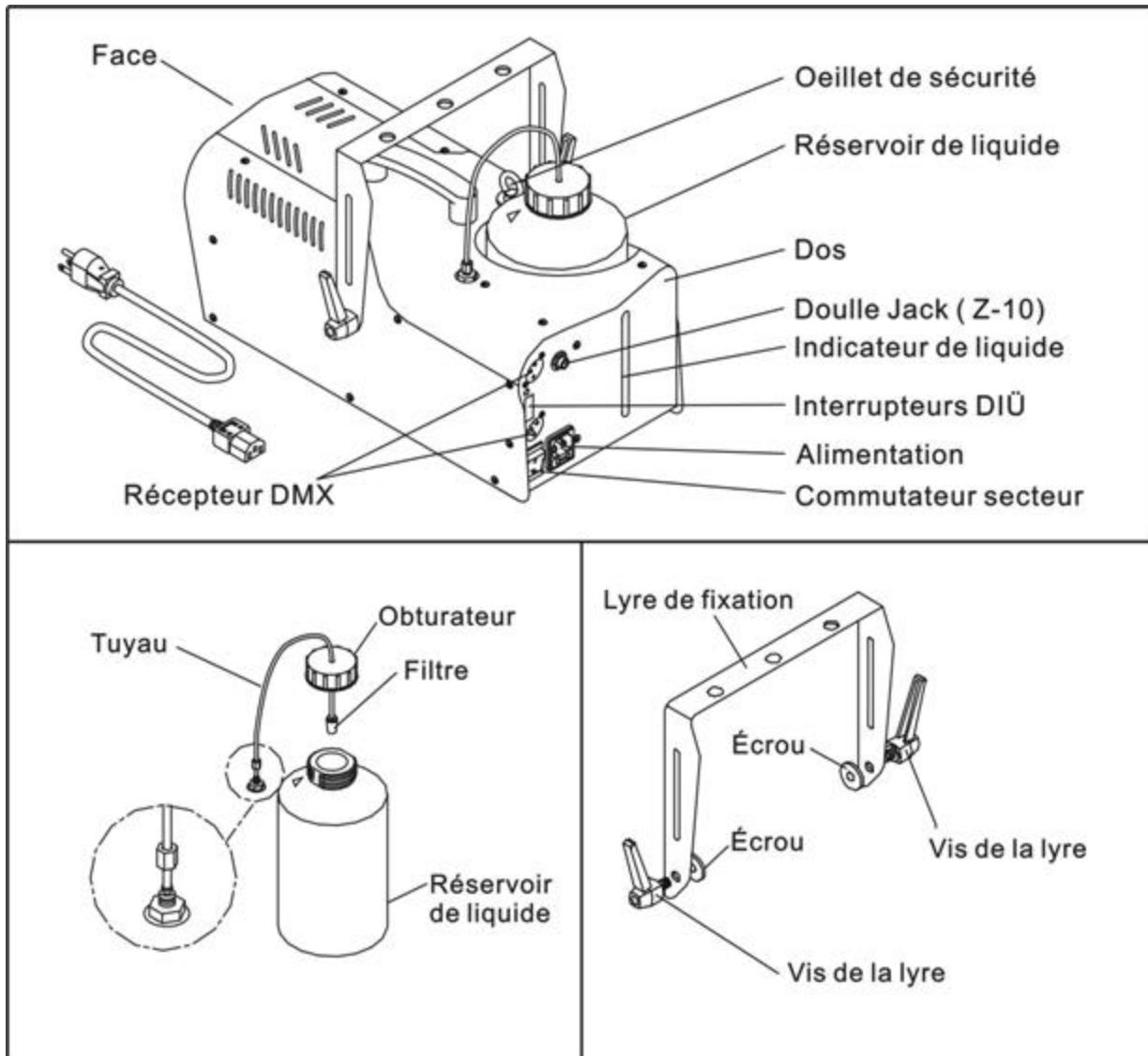
**Important:** Surveillez toujours le niveau de liquide à fumée dans le réservoir pendant les jets de fumée. Un emploi sans liquide à fumée peut endommager la machine.
