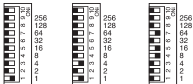
Adresse 1 Interrupteur N° 1 sur "ON" Adresse 88 (= 4 + 1) Interrupteur N° 3 et N° 1 sur "ON" Adresse 88 (= 64 + 16 + 8) Interrupteur N° 7, N° 5 et N° 4 sur "ON"
